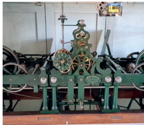
Auch die Turmuhr wurde revidiert und eine Pendelsynchronisation eingebaut. Das Pendel wird durch die neue Steuerung mit der aktuellen Zeit synchronisiert. Somit entfällt fortan das manuelle Nachjustieren der Uhr, welches vorher unser Mesmer ca. alle zwei Wochen durchführen musste.
